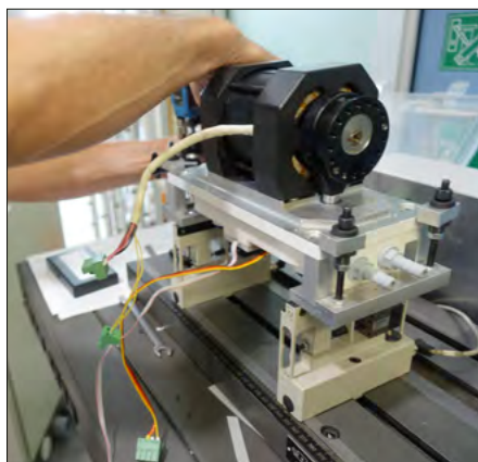
Der Motor mit Pumpenkopf wird dynamisch ausgewuchtet, was die VX4 besonders leistungsfähig macht.
